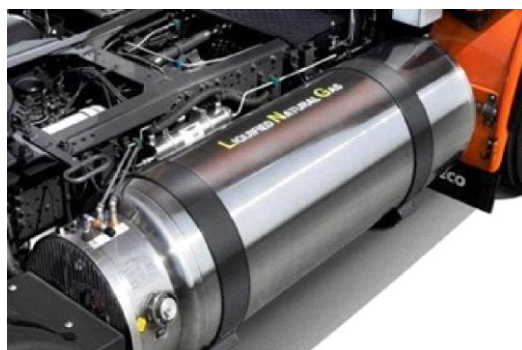
Figure 4 – LNG cryogenic tanks
